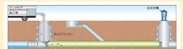
マンホールから紫外線を発光させる機械を管に入れ硬化させる。
